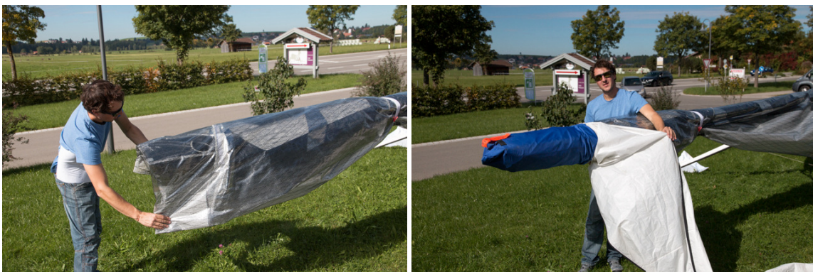
19.) Segel innen auf der Unterseite einschlagen und mittels Klettpolster am Holm fixieren
