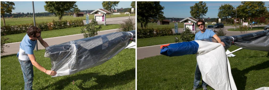
20.) Segel innen auf der Unterseite einschlagen und mittels Klettpolster am Holm fixieren
